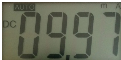
图 2.8.11b 实际电路测量结果（负载 1KΩ）
