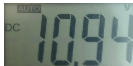
图 2.9.31 调压器电路实际输出
