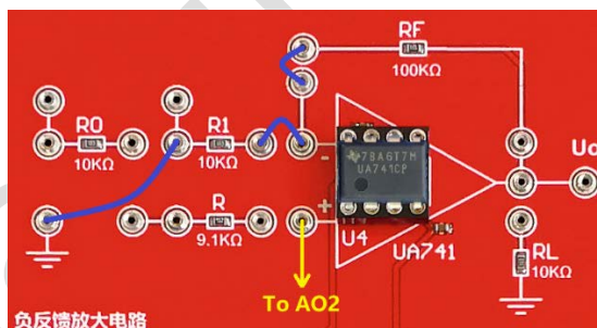
图 2.2.8 电压串联负反馈电路
